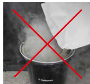
Door het overgieten in de emmer ontstaat een flinke hoeveelheid stof.
